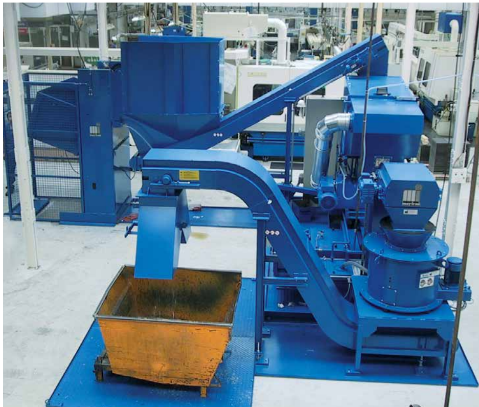
Installation som består av följande komponenter: spåncentrifug, spånkross, spåntransportör och lastsystem för containrar
