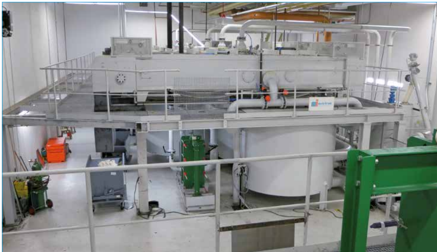
En tryckbandfilter-anläggning som består av flera filtermoduler
