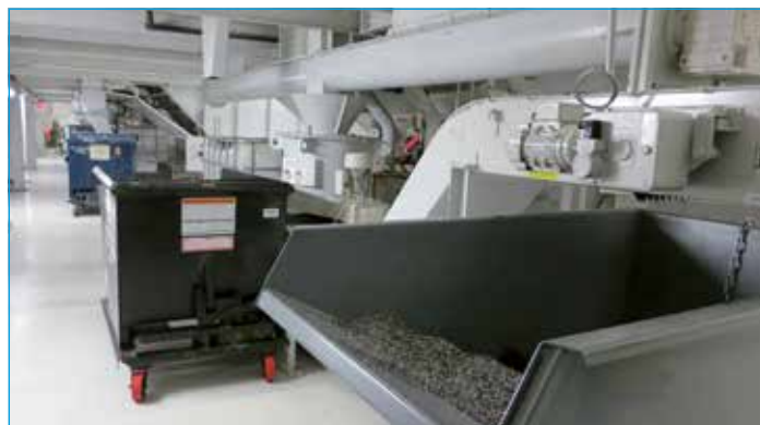
Zentrale Späneentsorgung durch MAYFRAN Späneförderer
