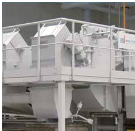
Föravskiljare vid ett vakuumfilter
